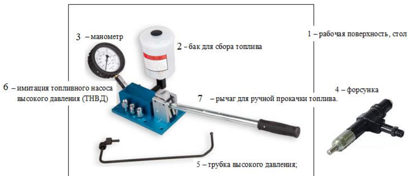
Рис. 1. Стенд для регулировки форсунок
