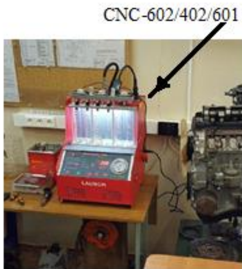
Рис. 1. Стенд для диагностики и ультразвуковой очистки форсунок CNC-602/402/601
