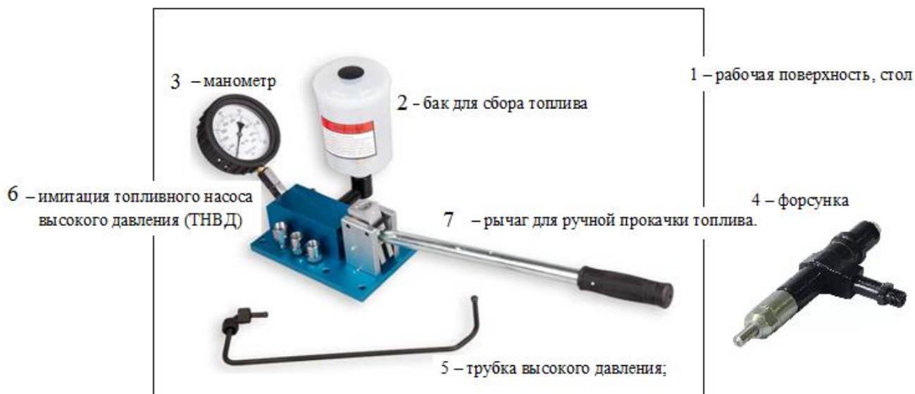
Рис. 1. Стенд для регулировки форсунок
