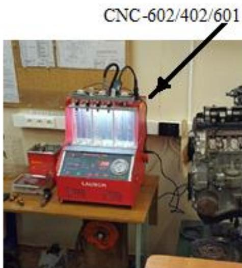
Рис. 1. Стенд для диагностики и ультразвуковой очистки форсунок
