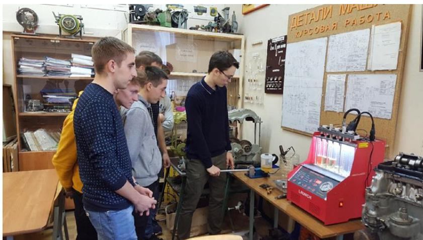
Рис. 1. Проведение лабораторной работы с применением станда для диагностики и ультразвуковой очистки форсунок
